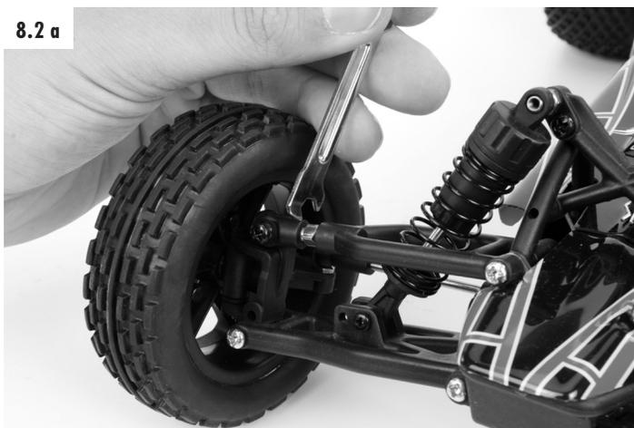
Negativer Sturz an den Vorderrädern erhöht die Seitenführungskräfte der Räder bei Kurvenfahrten. Die Lenkung spricht direkter an, die Lenkkräfte werden geringer. Gleichzeitig wird das Rad in Achsrichtung auf den Achsschenkel gedrückt. Das Fahrverhalten wird ruhiger.
